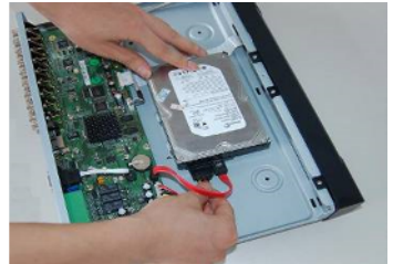
Sluit de kabel en de voedingskabel van de hard disk aan
