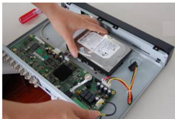
Plaats de 4 schroeven in de harddisk (niet vastschroeven)
