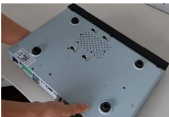
Draai het toestel en zorg ervoor dat de hard disk op de juiste plaats zit
