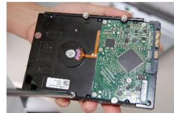
Plaats de schijf met de 4 schroeven in de daarvoor bestemde gaten
