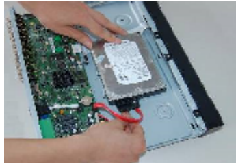
Sluit de kabel en de voedingskabel van de hard disk aan
