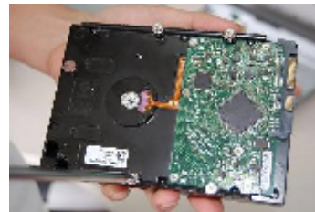
Plaats de schijf met de 4 schroeven in de daarvoor bestemde gaten
